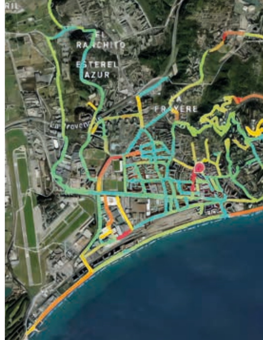
L'intelligence artificielle de la plateforme Vialytics permet d'analyser l'état de la route et de cartographier les résultats.
