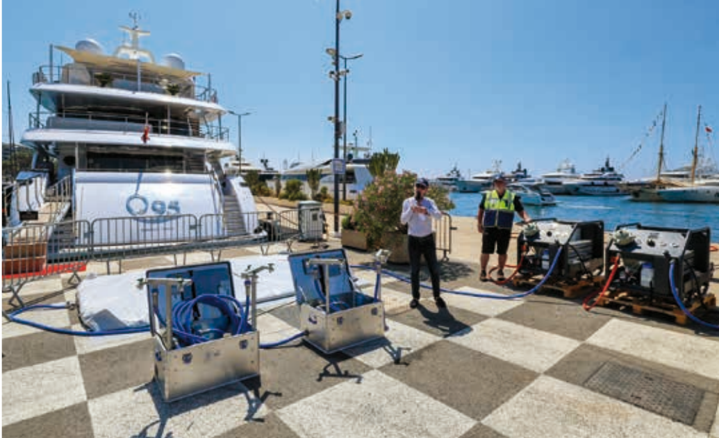
La Mairie de Cannes s'est équipée de deux unités mobiles pouvant traiter et désaliniser jusqu'à 700 litres d'eau de mer par heure.
