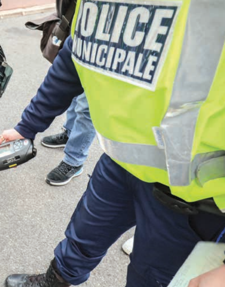
Les nouveaux sonomètres permettent de prendre la mesure précise, à un décibel près, du bruit émis par les véhicules.
