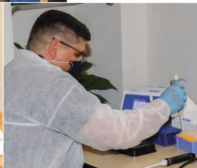
Le Maître-principal Éric du bataillon des Marins-pompiers de Marseille a réalisé une démonstration de test surfacique. Les éléments prélevés sur une table sont immédiatement analysés grâce à la Vita PCR, un petit appareil capable de détecter des maladies infectieuses en 20 minutes.
