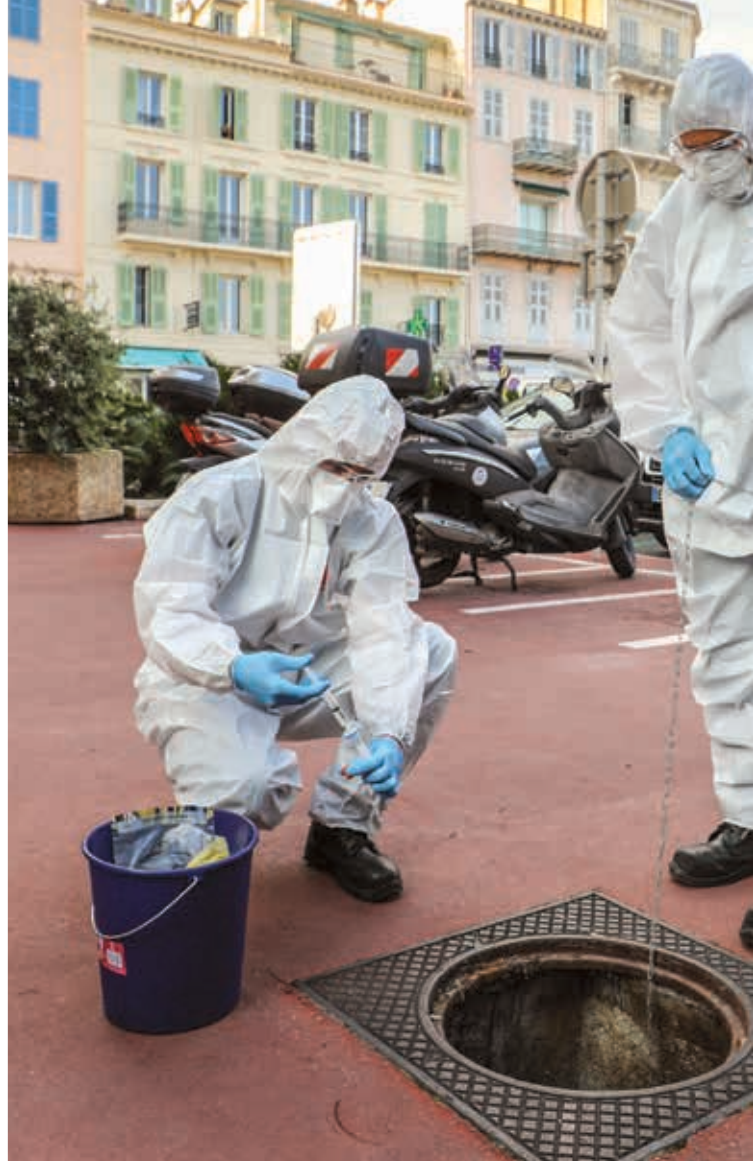
Les Marins-pompiers de Marseille du dispositif COMETE* ont procédé à une démonstration de prélèvement des eaux usées sur le collecteur de l'hôtel de ville, à l'aide notamment d'une seringue.
