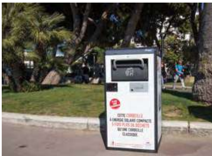
Les nouvelles corbeilles compactrices solaires et connectées installées à Cannes permettent un ramassage des déchets plus efficace, grâce au système de contrôle à distance de leur niveau de remplissage.
