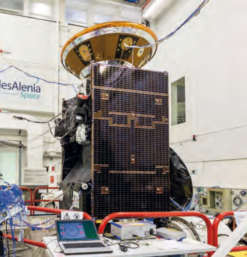
Un test clé : le passage en caisson vide thermique, qui recrée les variations de températures auxquelles il sera soumis dans son environnement spatial.
