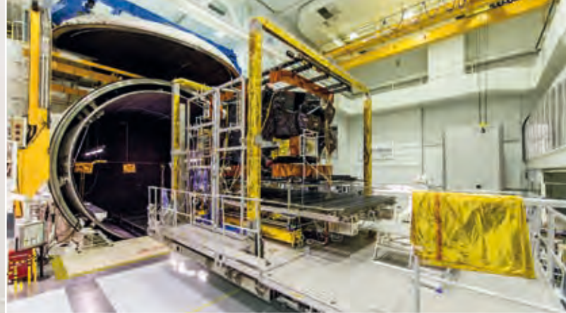
Un test clé : le passage en caisson vide thermique, qui recrée les variations de températures auxquelles il sera soumis dans son environnement spatial.
