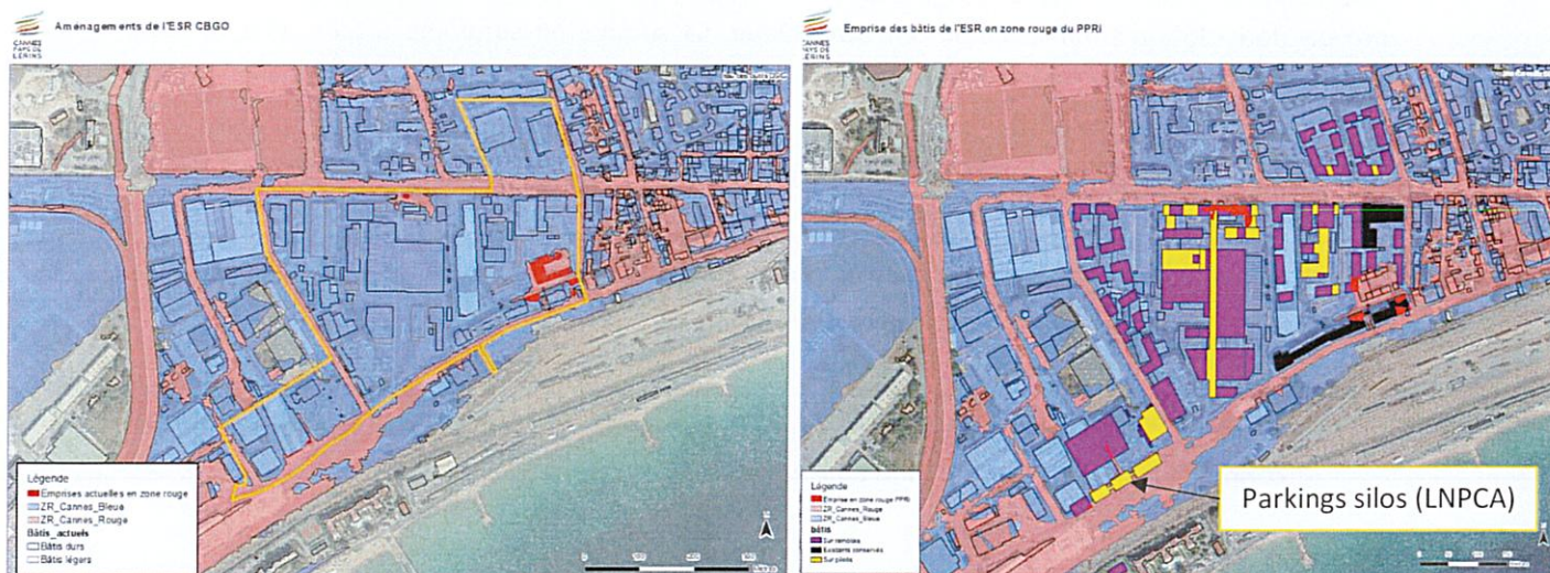
Figure 26 : Superposition des emprises bâties actuelles (à gauche) et projetées (à droite) de l'ESR et des zonages du PPRi
