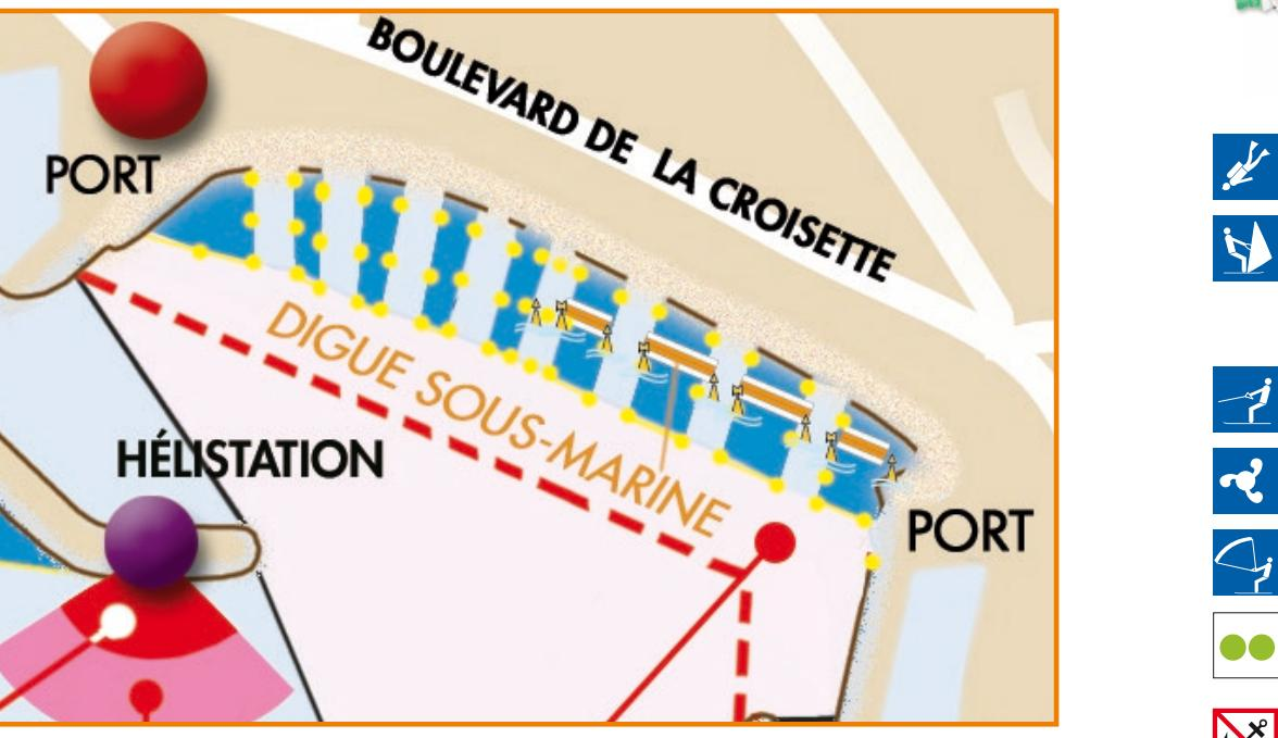
Une digue sous-marine a été construite le long des plages de la Croisette pour lutter contre l'érosion et limiter les dégâts provoqués par les coups de mer. Les quatre tronçons immergés de cet ouvrage, balisés en extrémité par des bouées isolées, se situent à 90 mètres du bord de plage et disposent d'un tirant d'eau inférieur à 1 mètre. La circulation de toute embarcation est interdite en dehors des chenaux de navigation et l'accès aux pontons doit se faire obligatoirement par les chenaux.
